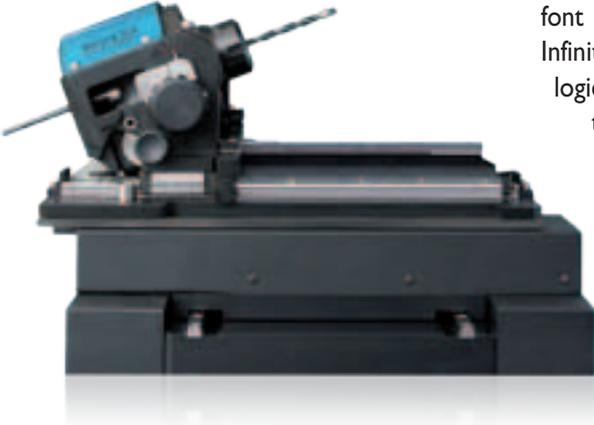
L'IF-Real3D mesure les rayons, les angles et la rugosité des arêtes de coupe. Source : Alicona
