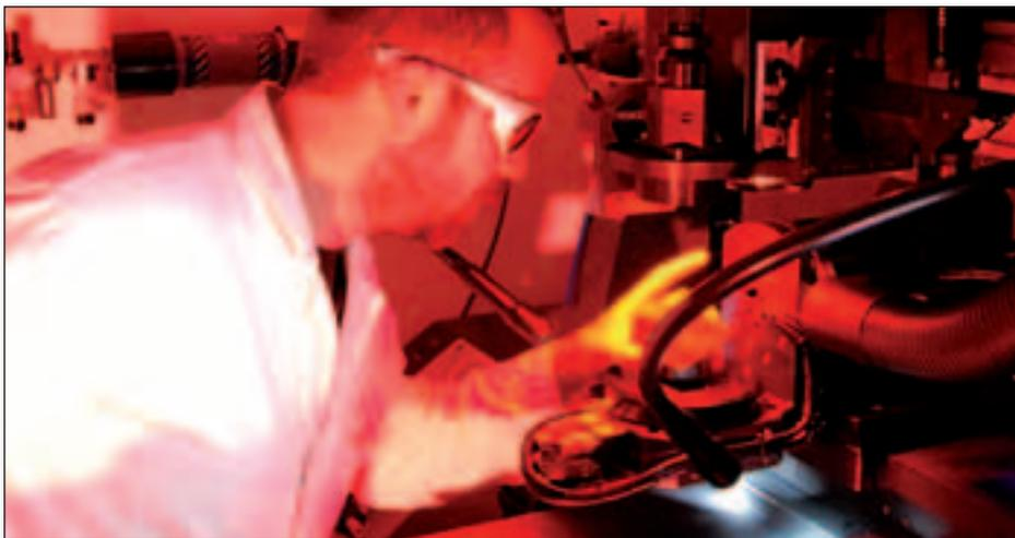
Inspection d'un dispositif photovoltaïque après un procédé d'ablation sélective de couches minces par laser.
