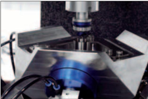
La machine TriNano utilise une table porte-pièce mobile afin de respecter le principe d'Abbe en 3D. Source : Trinano
