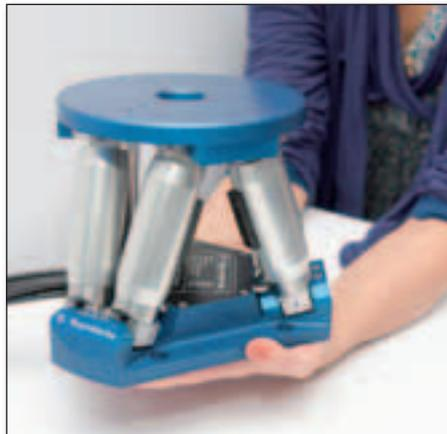
Une résolution de 0,1  $\mu\text{m}$ , 6 degrés de liberté pour un poids de 4,5 kg !
