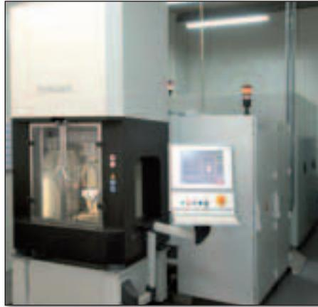
Selon Alain Funfrock, commercial France PEMTec, l'usinage électrochimique apporte des solutions d'applications jusqu'alors irréalisables d'un point de vue technique ou en termes de rentabilité (50 à 60 fois plus rapide que l'électroérosion !).
