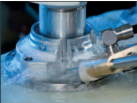
La finition électrochimique est un process libre de tout contact sans apport thermique. Source : Emag
