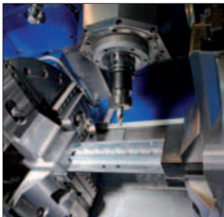
Séquence d'usinage sur un centre d'usinage MGP 300. Source : Cinetic Machining
