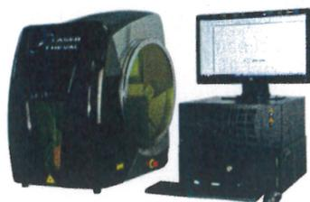
mode pulsé 150 W qu'en mode continu 250 W pour des besoins d'assemblage de pièces de très petites dimensions avec une vitesse de soudage et une qualité du cordon de soudure élevées.
