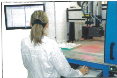
Le LEM Iolite, une machine laser avec système de vision pour marquage de pièces disposées en plateau. Source : Laser Cheval
